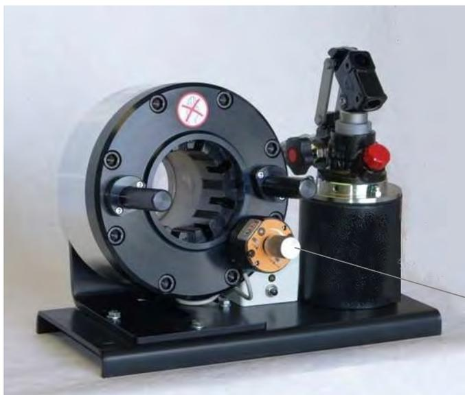
Presse à sertir compacte, précise, stable et transportable pour flexibles maximum 1 1/4"
