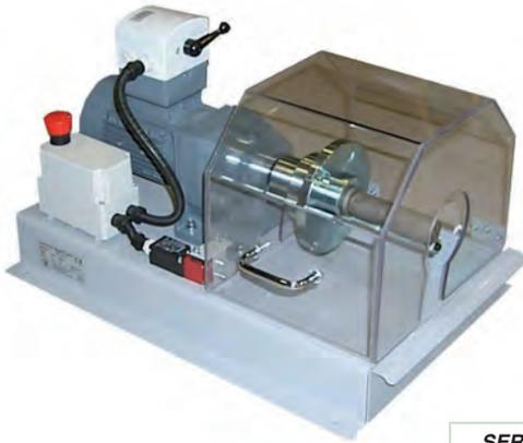
MidiSkive 5-50B est une machine de dénudage extérieur et intérieur (embouts série THP) des flexibles hydrauliques.
