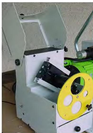
**Tronçonneuse-Dénudeuse à lame
