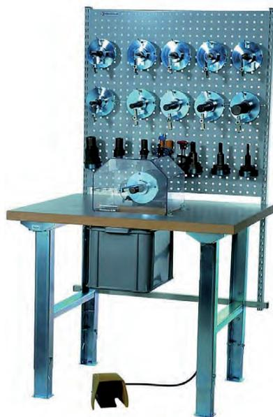
MidiSkive 5-50C est une machine de dénudage extérieur et intérieur (embouts série THP) des flexibles hydrauliques.
